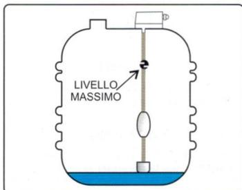
Dopo aver annodato la cordicella nel foro del contrappeso, e averla fatta passare nel galleggiante ovoidale, fermare il dischetto di arresto nella posizione di livello alto. Far passare quindi la cordicella nel foro eseguito nella parte superiore e annodarla nell'asticella del corpo esterno
