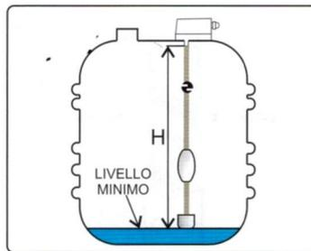
Misurare la profondità del serbatoio e tagliare la cordicella ad una lunghezza tale che il contrappeso legato ad una estremità, possa sfiorare il livello minimo di acqua
