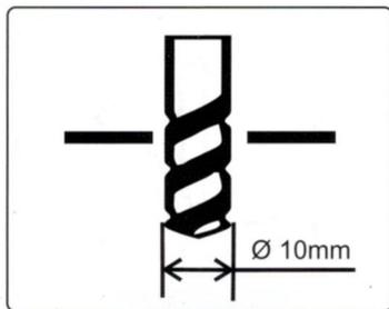
Praticare un foro da  $\varnothing 10\text{mm}$  sulla parte superiore del serbatoio. Il corpo principale può essere fissato o solo posato sulla parte superiore
